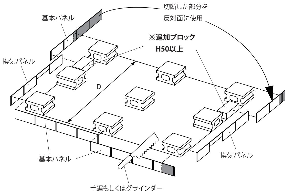
※継ぎ目部分がブロック上に来ない場合、上記図のように別途追加でH50以上のブロックを置いて下さい。
