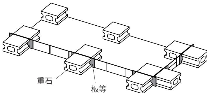
・設置場所に合わせてパネルの上下位置を調整してください。
